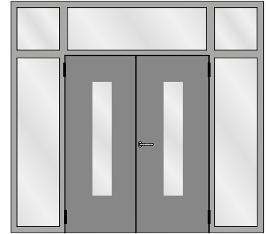
Verblechte zweiflügelige Türe mit zwei festen Seitenteilen und festen Oberlichtern Porte tôlée à deux vantaux avec deux parties latérales fixes et impostes fixes Sheet metal double leaf door with two fixed side lights and fixed top lights
