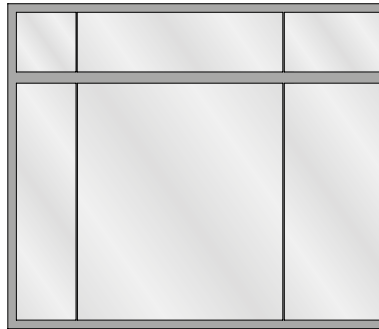
Stoßfugenverglasung Vitrage bord à bord Butt-joint glazing
